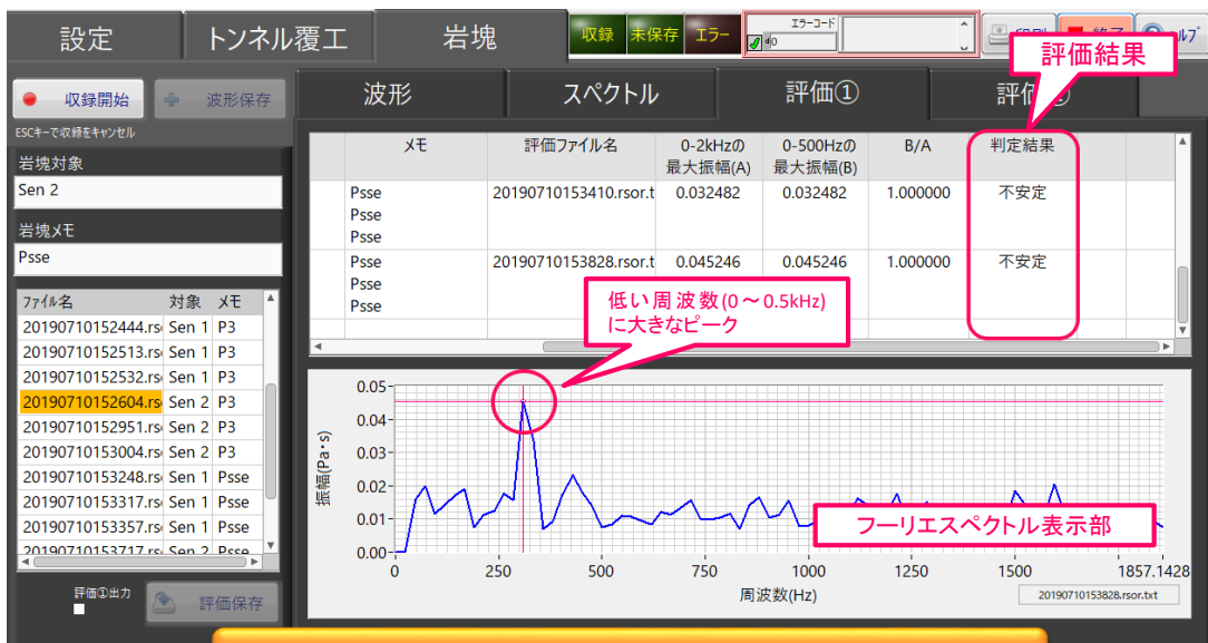
岩盤斜面中の岩塊の安定性評価の例
