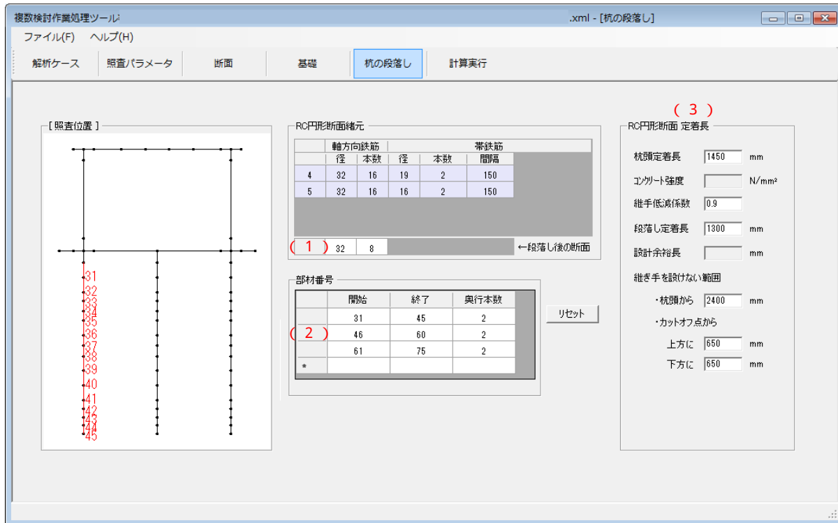
図 2 - 1 4 杭の段落しの設定画面
